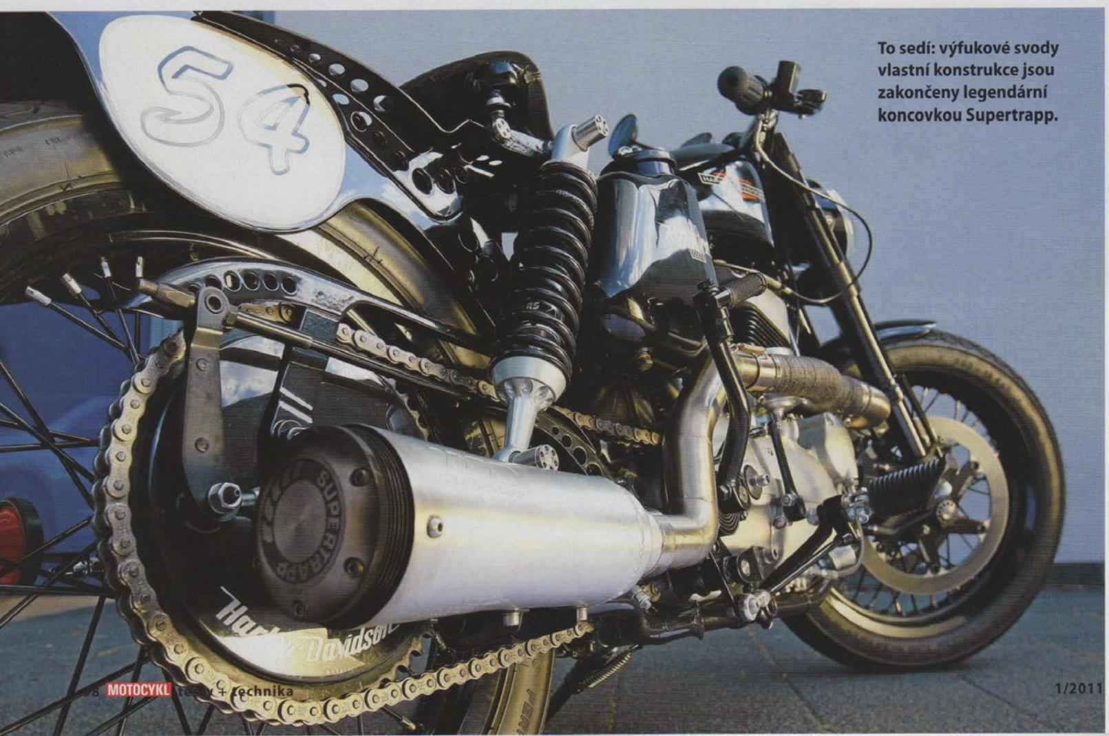
To sedí: výfukové svody vlastní konstrukce jsou zakončeny legendární koncovkou Supertrapp.
