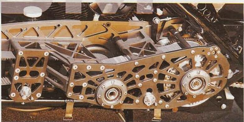
Přenos síly pomocí transmise: oba motory spojuje jeden Gatesův ozubený řemen, další se stará o přenos síly na suchou spojku. Sekundární pohon je řešen standardním řetězem s O-kroužky. Velmi netradiční: výfukové potrubí je fixováno několika nastavitelnými táhly [foto vlevo].
