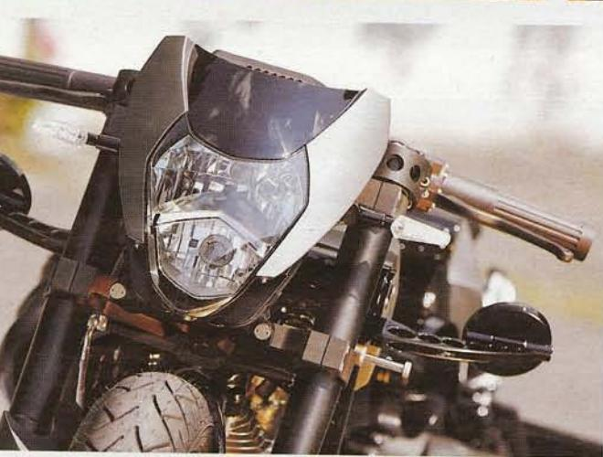
Z jednoho kusu: zrcátka jsou vyfrézována z jednoho kusu aluminia, přední maska pochází z modelu GSX-R 1000 a na přední vidlice je uchycena držákem vlastní konstrukce.
